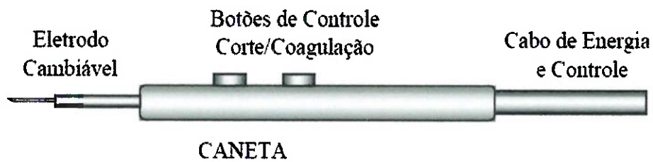
Figura 1.1.3: Bisturi Elétrico – componentes de um bisturi elétrico
